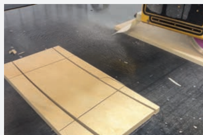
Radiales Sägen von Pool-Platten
